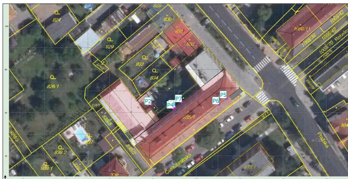
Obr.č. 1 Umístění výustek VZT jednotek na objektu školy
